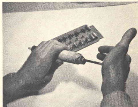
Comprimendo la molla del dispositivo si mette l'aspiratore in grado di funzionare.
